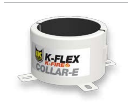
K-FLEX® K-FIRE COLLAR-E to stalowa kasetka z wkładem pęczniejącym przeznaczona do zabezpieczania rur palnych, izolowanych rur metalowych oraz kabli
