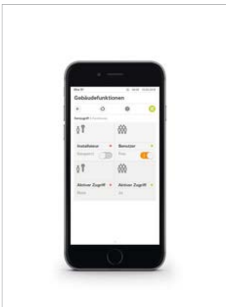
Rys. 10. Za pomocą smartfona lub innego urządzenia mobilnego można zezwolić na dostęp do instalacji innej osobie fot. archiwum GIRA
