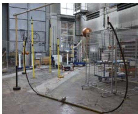
Badanie przewodu w izolacji wysokonapięciowej
