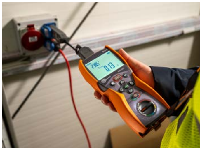
Pomiar impedancji pętli zwarcia miernikiem Sonel MPI-507
