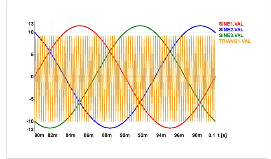
Rys. 4. Sygnały sterujące trójfazowej modulacją sinusoidalnej falownika zasilacza UPS rys. M. Żurek-Mortka, K. Kuczyński
