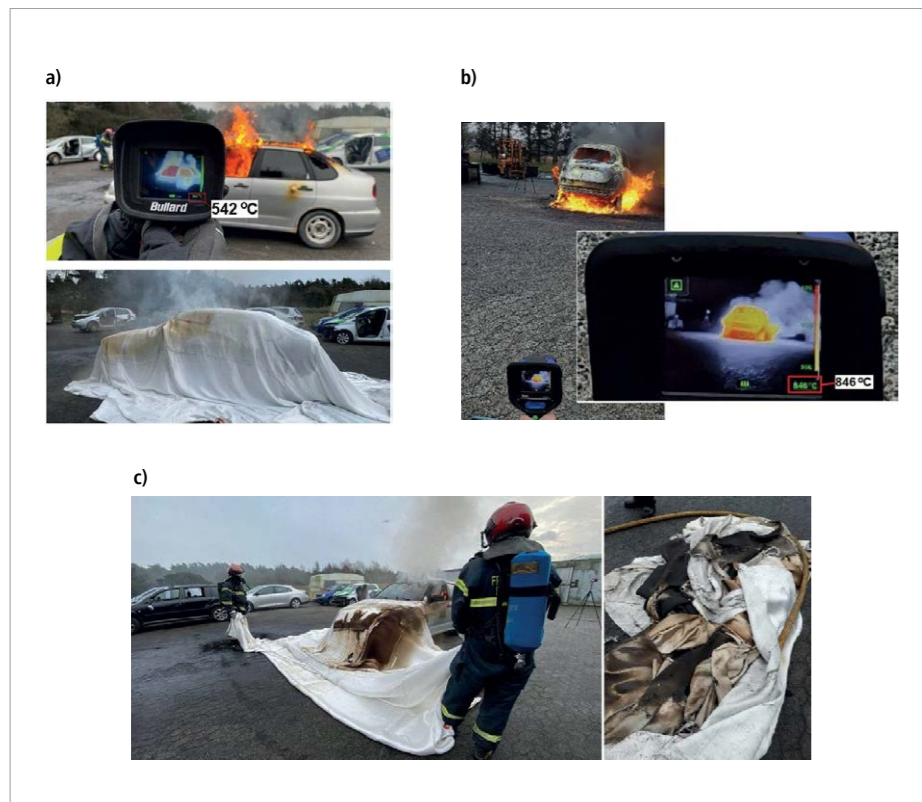
Rys. 5. Badania odporności koca gaśniczego: a) pomiar temperatury pożaru pojazdu spalinowego i widok stanu koca, b) pomiar temperatury pożaru pojazdu elektrycznego, c) widok stanu koca po stłumieniu pożaru pojazdu elektrycznego [25]
