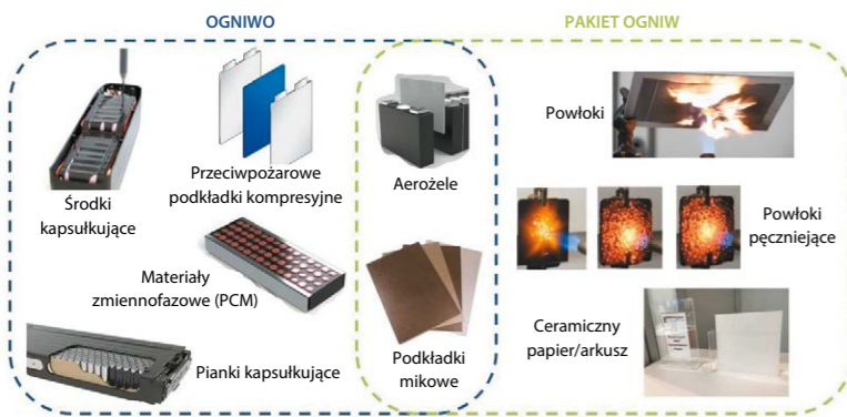
Rys. 3. Materiały przeciwpożarowe używane w konstrukcji baterii pojazdu elektrycznego [8]
