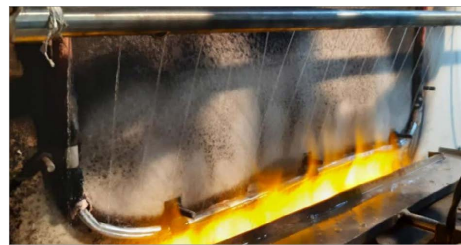
Rys. 5. Test podtrzymania funkcji przesyłu sygnału optycznego wg EN 50200:2015+E
