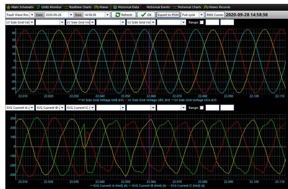
Rys. 4. Brak stanów niestabilnych przy operacjach łączeniowych – zmiana charakteru mocy układu w zakresie \pm 11 Mvar przy napięciu 30 kV. Wykres górny: napięcie na szynach rozdzielni 30 kV. Wykres dolny: prąd układu SVG
