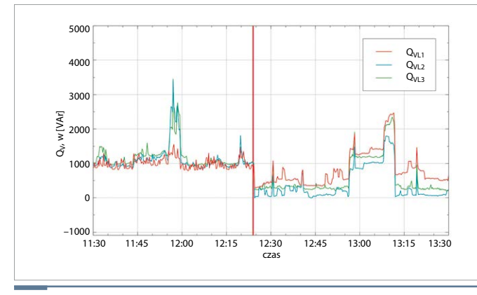
Rys. 8. Wykres zmienności poboru mocy biernej składowej podstawowej 50 Hz ( Q_v ), dla trzech faz, przy działającym kompensatorze i po jego wyłączeniu (linia czerwona) rys. A. Książkiewicz
