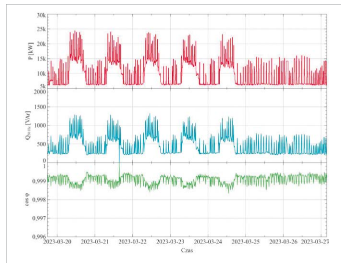
Rys. 4. Wykres zmian wartości mocy czynnej, biernej składowej podstawowej 50 Hz i współczynnika mocy dla pojedynczego, wybranego tygodnia pracy rys. A. Książkiewicz
