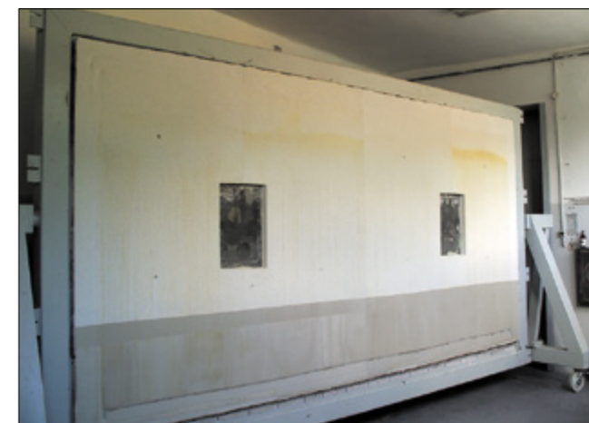
Ściana testowa ETAG 004 po testach w komorze klimatycznej Fot. SSO
