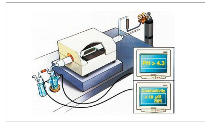
Fot. 3. Badanie gazów korozyjnych wydzielanych podczas pożaru [1]
