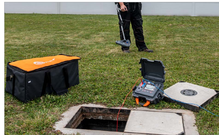
Fot. 1. Sprawdzanie terenu za pomocą lokalizatora Sonel LKZ-2500
