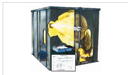
Rys. 3. Stanowisko badawcze według PN-EN 61034-1:2010 rys. W. Jaskółowski
