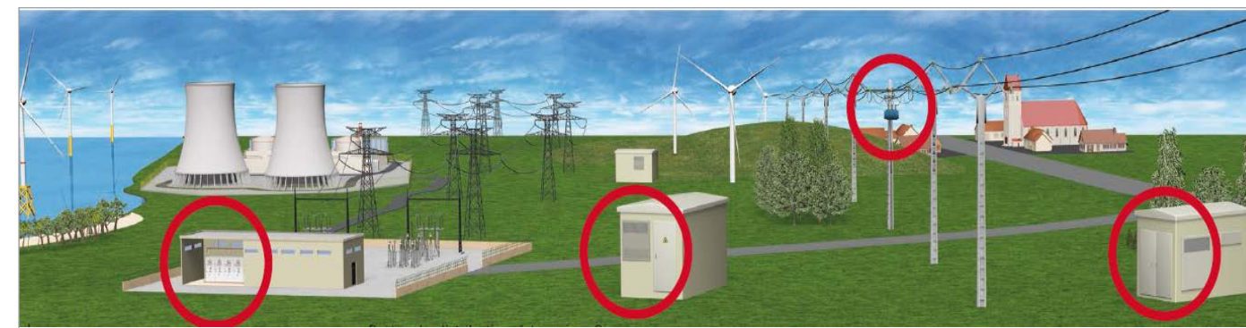
Rys. 2. Pomiar parametrów sieci kablowej w punktach rozgałęźnych.
