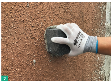
FOT. 5–8 Przykład weryfikacji nośności podłoża uproszczoną metodą odrywania kostki styropianu; fot.: autor
