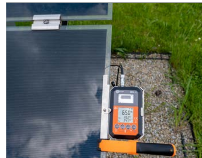
Rys. 3. Miernik nasłonecznienia i temperatury Sonel IRM-1
