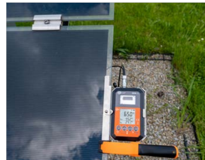
Rys. 3. Miernik nasłonecznienia i temperatury Sonel IRM-1
