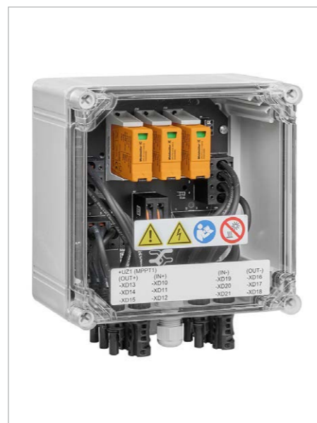
Rozdzielnice PV Next chronią system fotowoltaiczny przed przepięciami i zwarciami, a także zapewniają opcję łączenia stringów
