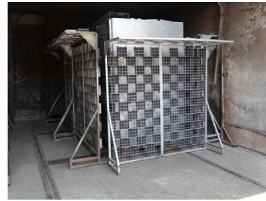
Rys. 1. Rozdzielnica e 2 ALPHA 12 kV, 40 kA podczas prób łukowych oraz przykład nieudanej próby łukowej rys. W. Chmielak
