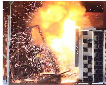
Rys. 1. Rozdzielnica e 2 ALPHA 12 kV, 40 kA podczas prób łukowych oraz przykład nieudanej próby łukowej rys. W. Chmielak
