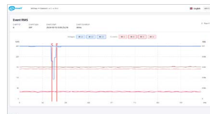
Rys. 5. Webserwer – wykresy przykładowego zarejestrowanego zapadu napięciowego
