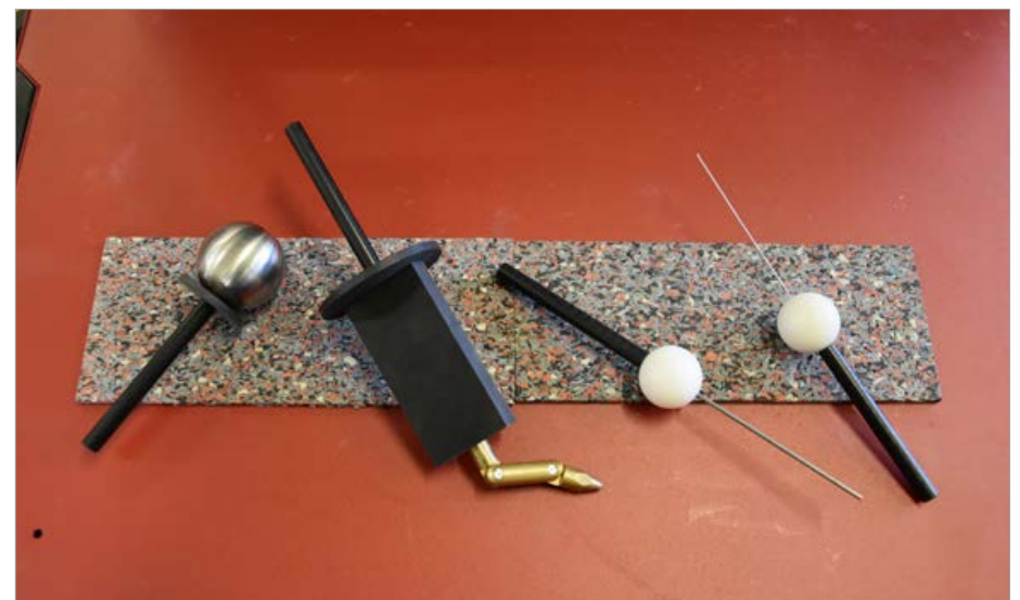
Fot. 1. Próbniki dostępu w wersji podstawowej (bez przyłączy obwodu sygnalizacyjnego): kula probiercza o 50 mm z rękojeścią, palec probierczy o 12×80 mm, pręt probierczy o 2,5×100 mm, drut probierczy o 1,0×100 mm
