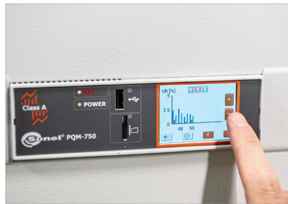
Fot. 4. Sonel PQM-750 – wbudowany ekran do obsługi analizatora w miejscu zainstalowania
