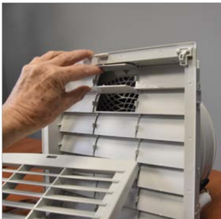
Fot. 4. Wentylator z uchylnymi dwiema klapkami grawitacyjnymi. Żaluzja odjęta
