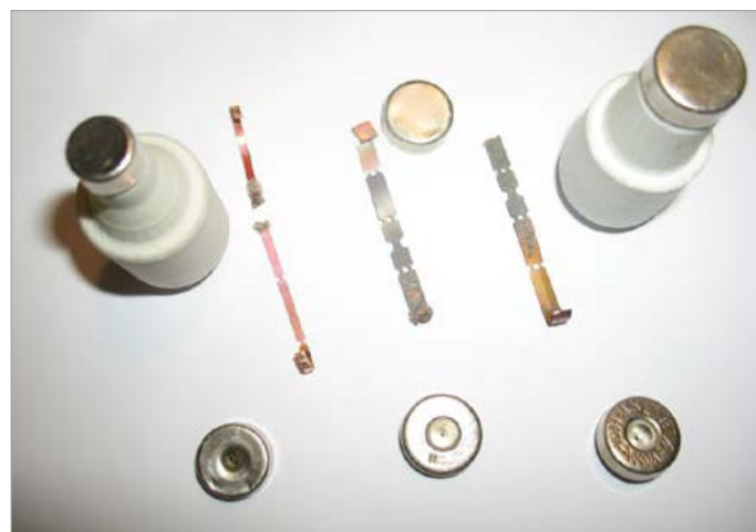
Fot. 1. Przykładowe rozwiązania topików w bezpiecznikach cylindrycznych fot. JT
