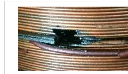
Rys. 9. Uszkodzenie uzwojenia GN testowanego obiektu nr 1
