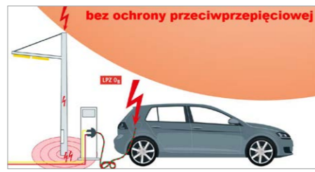
Rys. 7. Przykład pojedynczego przyłącza stacji ładowania pojazdów elektrycznych, w której brak jest ochrony przeciwprzebieciowej. Zagrożony jest samochód i sama stacja rys. J. Wiater
