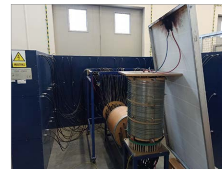
Fot. 18. Stanowisko do badania wytrzymałości na prąd piorunowy panelu PV – w tle generator prądu doziemnego wyładowania piorunowego [zdjęcie JW]
