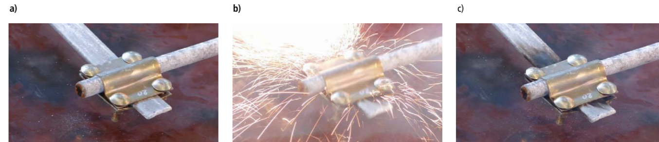
Rys. 11. Złącze krzyżowe składane przed (a), podczas badań (b) i po badaniu (c) prądem o wartości 100 kA i kształcie 10/350 μs fot. J. Wiater
