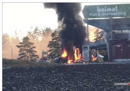
Rys. 3. Pożar samochodu elektrycznego podczas ładowania [3]
