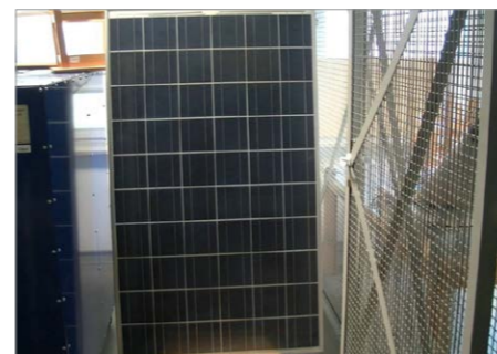
Fot. 12. Stanowisko do badań wytrzymałości udarowej (1,2/50 μs) paneli PV [zdjęcie JW]
