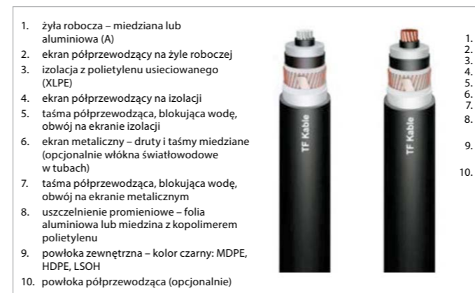
Rys. 5. Budowa typowego kabla elektroenergetycznego WN o izolacji XLPE i z ekranem z drutów miedzianych [4]
