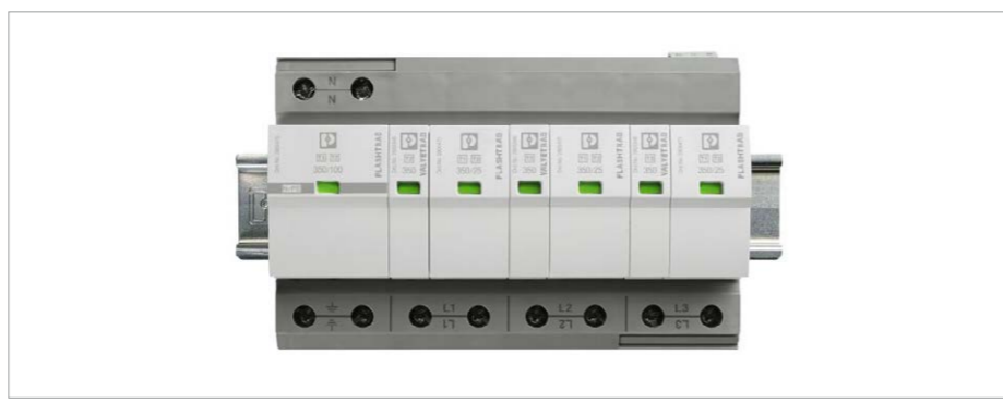
Rys. 1. Uniwersalna, rzeczywista kombinacja dwóch różnych ograniczników przepięć dla pięcioprzewodowych układów sieci zasilania do ochrony obiektów od klasy ochrony IV do klasy I
