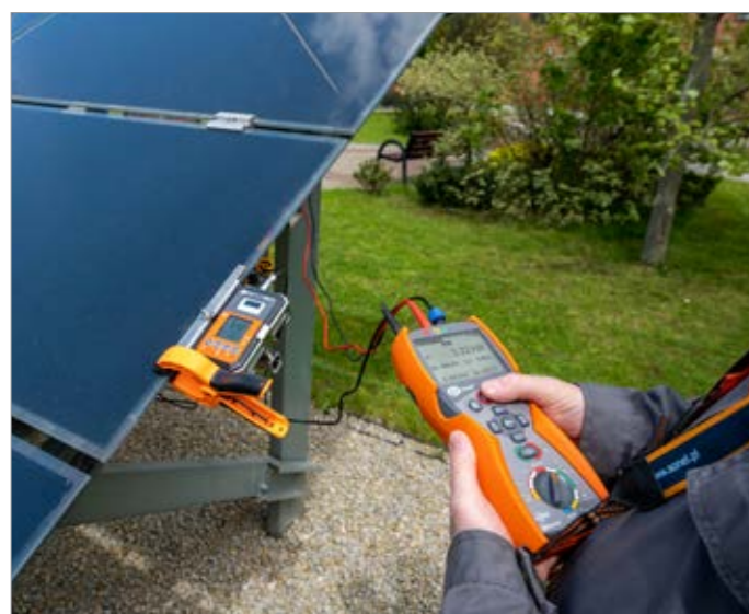
Rys. 1. Wykorzystanie mierników zestawu Sonel PVM-1020 KIT do badania instalacji fotowoltaicznej
