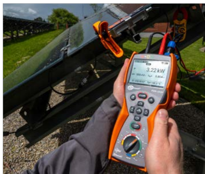
Rys. 2. Pomiary paneli fotowoltaicznych miernikiem Sonel PVM-1020
