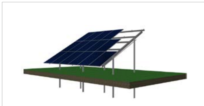
Najszybsze w montażu są konstrukcje montowane poprzez wbijanie ocynkowanych profili w grunt Fot. Elpuk
