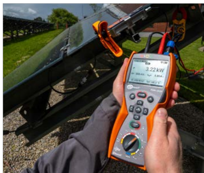
Rys. 2. Pomiary paneli fotowoltaicznych miernikiem Sonel PVM-1020
