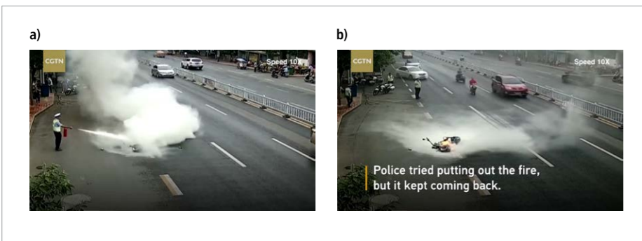
Rys. 8. Nieskuteczność gaśnicy podczas gaszenia skutera elektrycznego zasilanego z baterii litowo-jonowej: a) gaszenie skutera przez policjanta, b) powrót płomieni źródło: YouTube [8]
