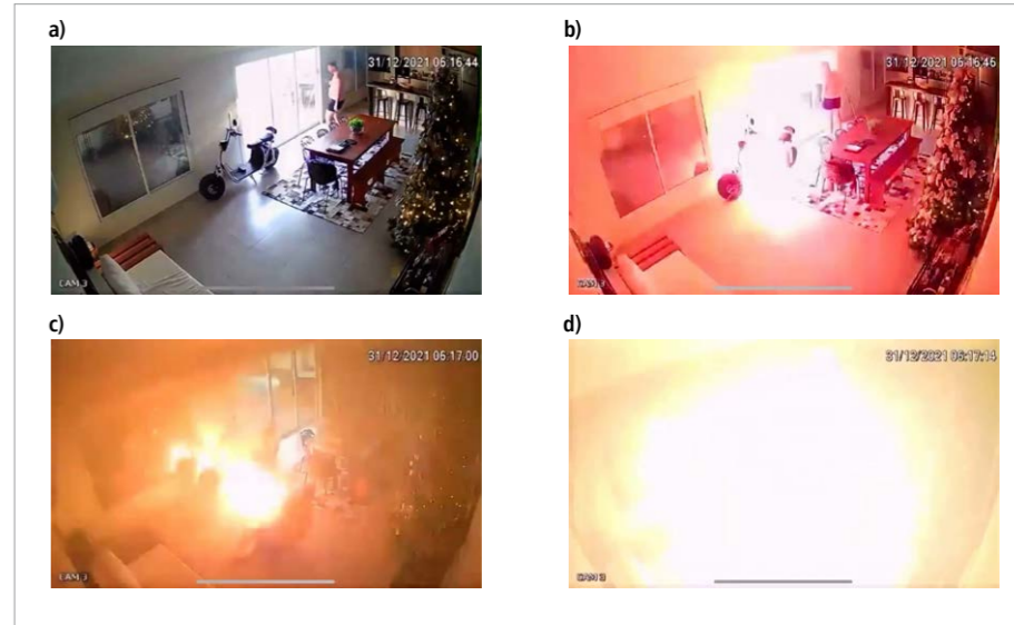
Rys. 4. Kolejne etapy rozwoju pożaru skutera elektrycznego w mieszkaniu podczas procesu ładowania: a) ładowanie skutera elektrycznego – ładowarka leży na baterii, b) nagłe pojawienie się płomieni, c) 15 sekund później, d) 45 sekund od rozpoczęcia się pożaru Źródło: YouTube [4]
