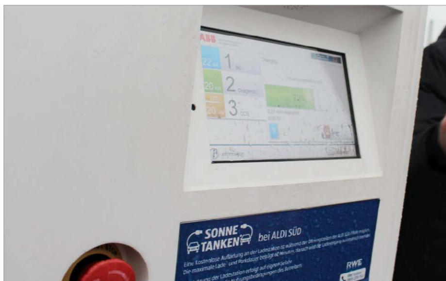
Fot. 1. Przykład procesu ładowania samochodu ze stacji ładowania zasilanej z instalacji fotowoltaicznej przy jednej z sieci handlowych
