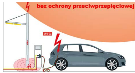
Rys. 7. Przykład pojedynczego przyłącza stacji ładowania pojazdów elektrycznych, w której brak jest ochrony przeciwprzebiegowej. Zagrożony jest samochód i sama stacja rys. J. Wiater
