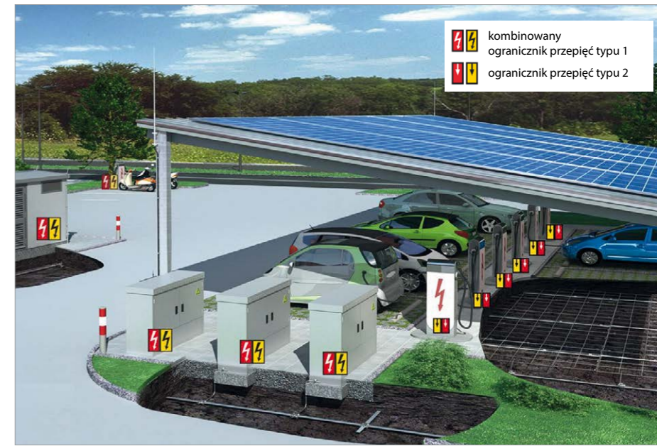
Rys. 11. Przykład ochrony stacji ładowania pojazdów połączonej z instalacją PV rys. J. Wiater
