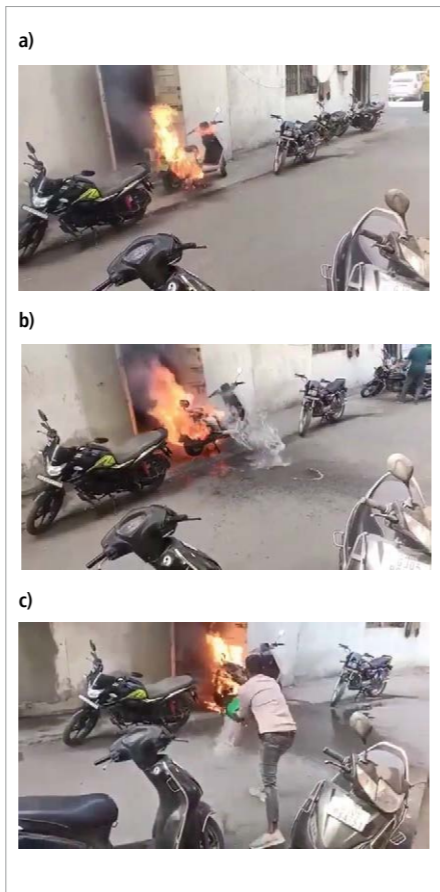
Rys. 9. Nieskuteczność wody podczas gaszenia pożaru baterii litowo-jonowej: a) pożar, b) użycie wody, c) brak widocznych rezultatów źródło: YouTube [9]
