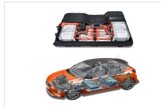
Rys. 2. Rama wraz z okablowaniem oraz przykład umiejscowienia baterii w samochodzie elektrycznym [5, 6]
