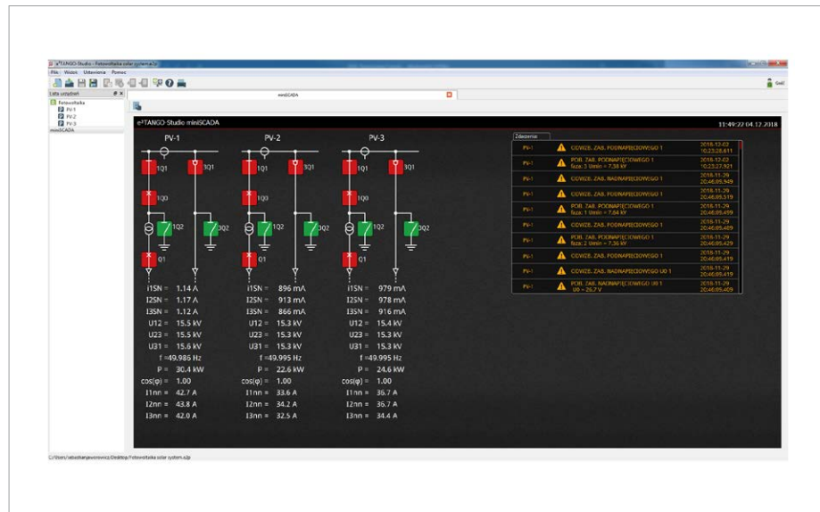
Rys. 4. Widok okna oprogramowania inżynierskiego e²TANGO-Studio z uruchomioną funkcjonalnością miniSCADA dla elektrowni fotowoltaicznych PV
