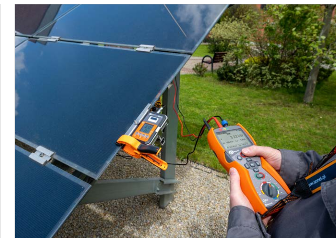
Badanie instalacji fotowoltaicznej miernikami zestawu Sonel PVM-1020KIT (PVM-1020 i IRM-1)
