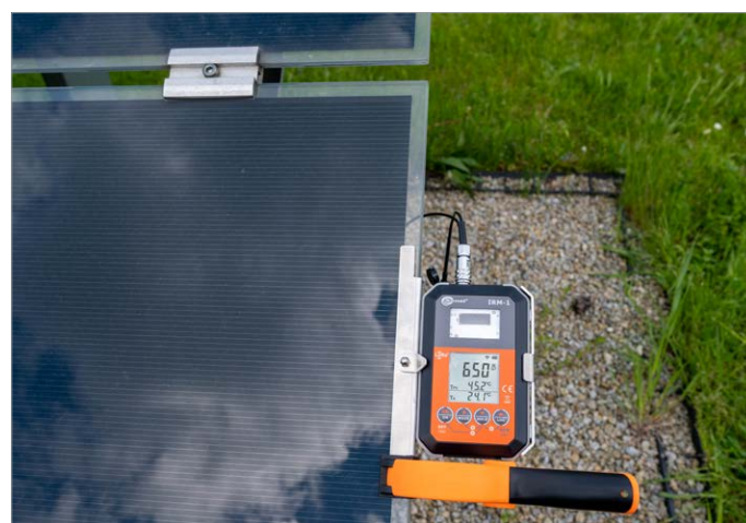
Badanie instalacji fotowoltaicznej miernikiem Sonel IRM-1
