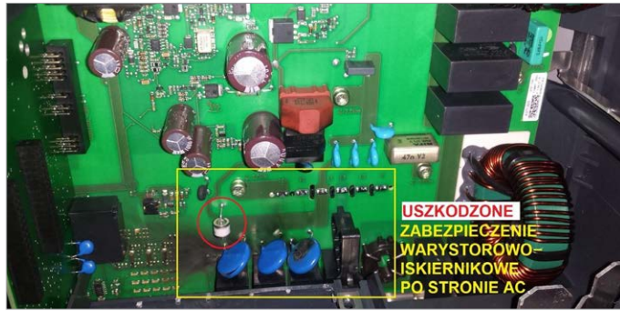
Rys. 3a. Uszkodzony falownik PV [1]
