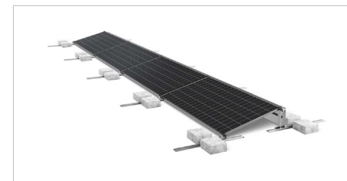
System Corab PB-068 to konstrukcja balastowa na dach płaski. Kąt nachylenia to 15 st. Wykonana z wysokiej klasy aluminium oraz stali nierdzewnej. Pozwala na orientację modułów na południe. Na system składa się również wiatrownica. Aby ochronić dach przed ewentualnym zniszczeniem, wykorzystano specjalną izolację. Istnieje możliwość połączenia rzędów ze sobą Fot. Corab
